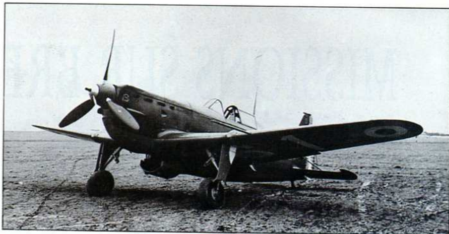
Le MS 406 : 2 435 kg, puissance moteur 960 CV, vitesse de croisière 400 km/h
