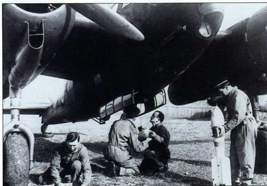
L'armement du Breguet 693 : 1 canon de 20 mm, 4 mitrailleuses de 7,5 mm et 8 bombes de 50 kg.
