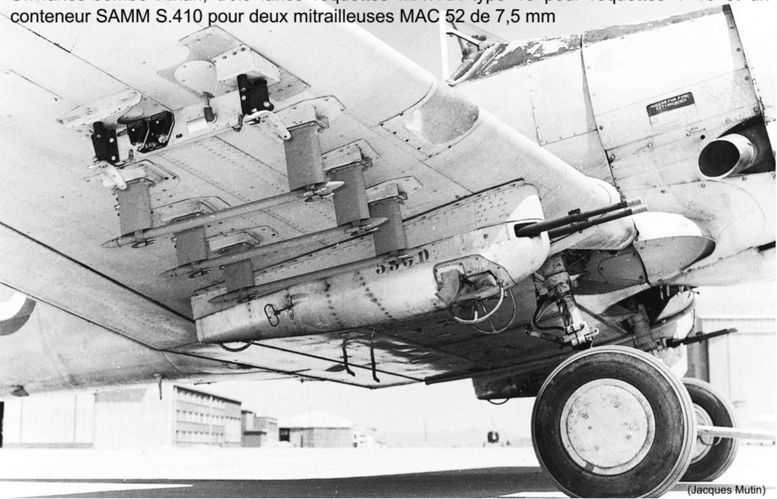
EALA 3/12 à Bougie – Avant la pose des containers, à droite : un lance-roquettes LR 361 pour 36 roquettes SNEB 37 mm
