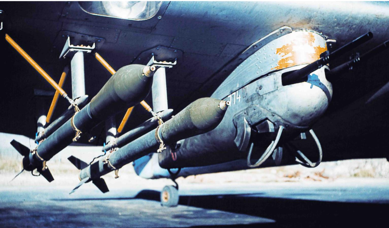
Un lance-bombe Alkan, trois lance roquettes MATRA type 13 pour roquettes T 10 et un conteneur SAIM S.410 pour deux mitrailleuses MAC 52 de 7,5 mm
