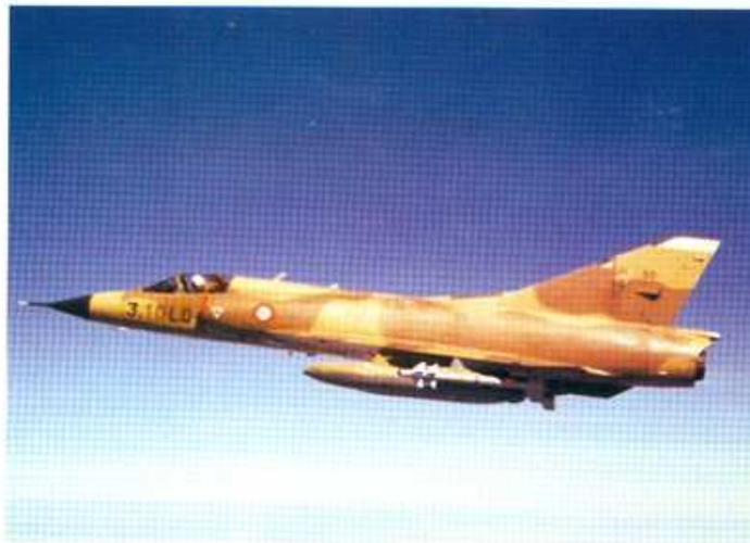
Mirage III C équipé de missiles MAGIC, les appareils en place à DJIBOUTI sont modifiés pour le tir de ces missiles.
