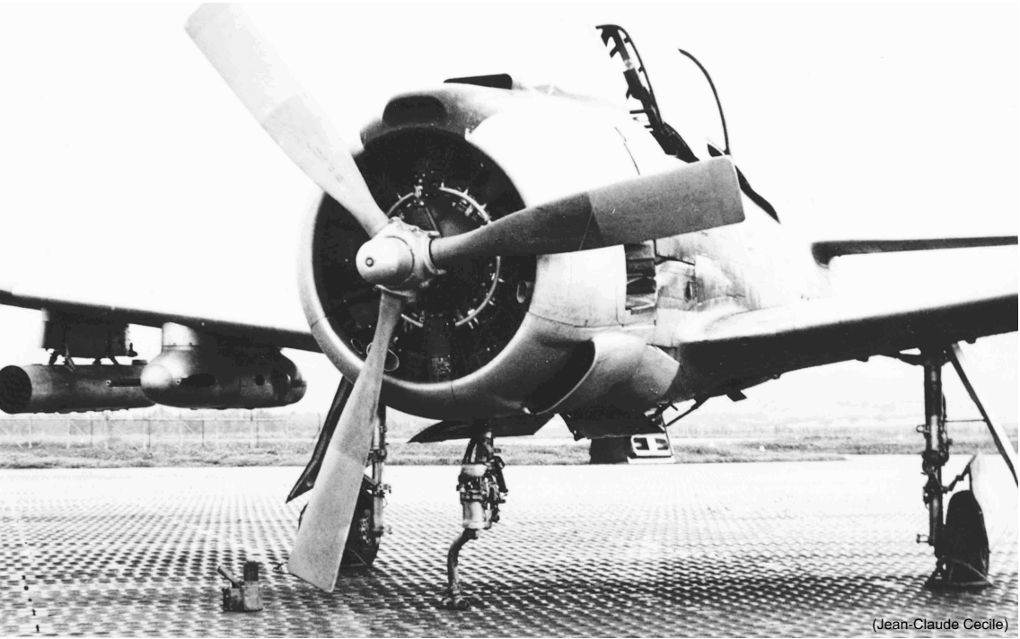
EALA 3/10 – T-28 à Batna, intervention sur le train avant
