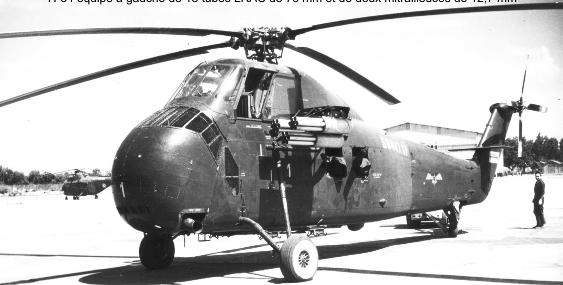
H-34 équipé à gauche de 18 tubes LRAC de 73 mm et de deux mitrailleuses de 12,7 mm
